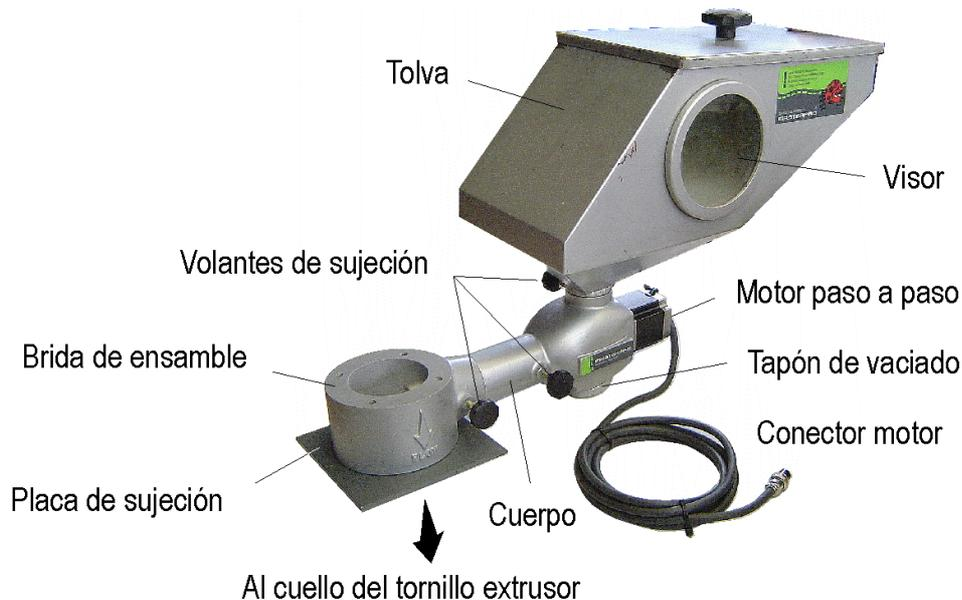
4.5. Conecte eléctricamente el motor paso a paso al controlador (Ver "Conexión eléctrica"), disponiéndolo en un lugar seguro, seco, visible y lejos de fuentes de calor.
